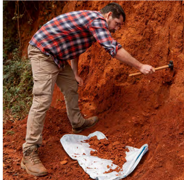
ETAPA 3. Forrar a base do barranco com enxadão ou sacho e retirar amostras uniformemente em diferentes posições sem abrir buracos para assim evitar danos à estrutura do barranco e, logo, desmoronamentos e erosão. Retirar amostras com cuidado para evitar contaminações com materiais de origem orgânica ou outros tipos de solos. Sempre limpar bem as ferramentas a cada coleta.
