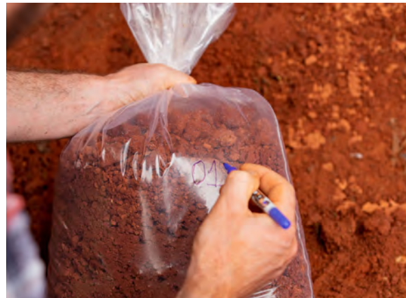
ETAPA 4. Armazenar em sacos plásticos, amarrar com barbante e identificar a amostra.
