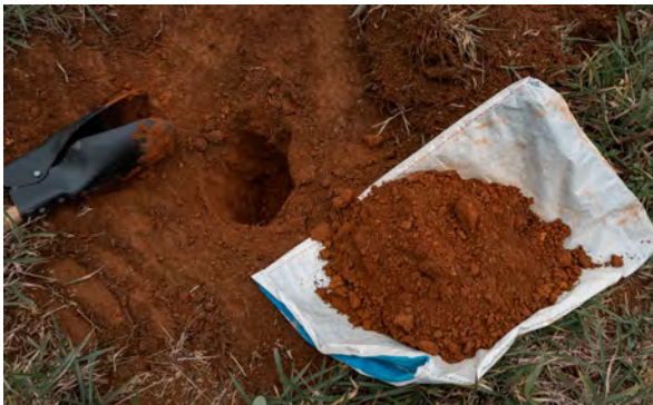
ETAPA 2. Cavar com enxadão ou cavadeira para retirar amostras com cuidado para evitar contaminações com materiais de origem orgânica ou outros tipos de solos. Sempre forrar com saco plástico e limpar bem as ferramentas a cada coleta.
